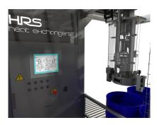
La Serie HRS AF de llenadoras asépticas de cabezal simple y doble están diseñadas para su uso con soluciones de envasado estéril tipo 'bag-in-box' y 'bag-in-drum'. En el proceso, la esterilización térmica del producto se lleva a cabo por separado de la del envasado. Las condiciones estériles durante el envasado se mantienen usando vapor, de modo que el producto refrigerado o a temperatura ambiente se puede poner en el contenedor sin que haya contaminación antes de que el envase esté sellado.
