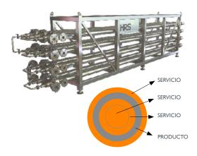
El intercambiador de triple tubo modelo AS 4 se utiliza para aplicaciones de fluidos viscosos. Este intercambiador está formado por cuatro tubos concéntricos. El producto circula por el canal existente entre el segundo y el tercer tubo. El servicio circula por los otros dos canales. De esta forma, el producto es calentado o enfriado por ambos lados.
